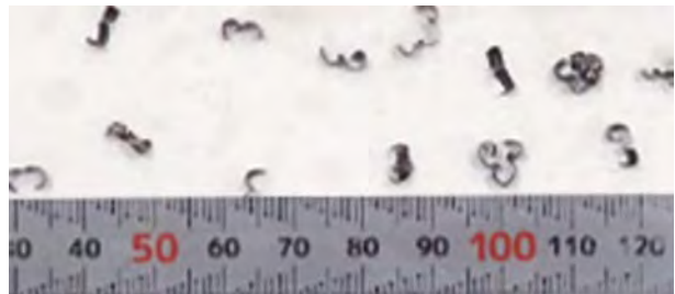
Butzenbildung im Zentrum: \varnothing 1.42 mm, Rz: 0.015 mm
