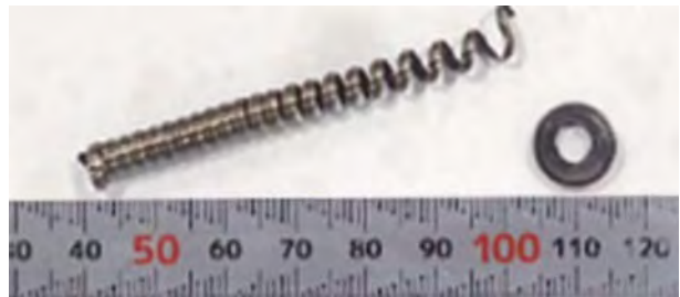
Butzenbildung im Zentrum: \varnothing 0.49 mm, Rz: 0.009 mm
