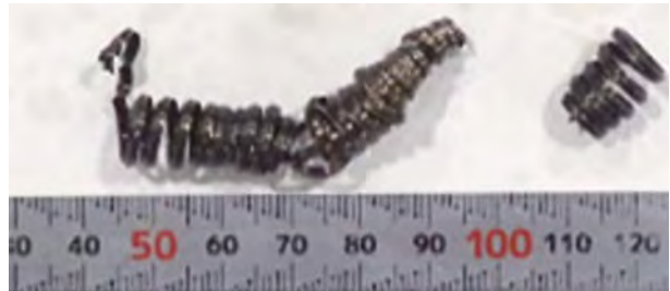
Butzenbildung im Zentrum: \varnothing 0.58 mm, Rz: 0.043 mm
